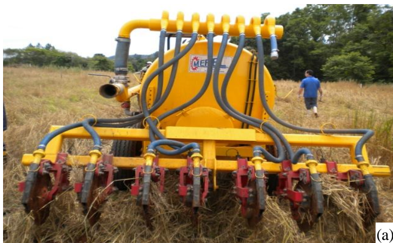
Figura 3 Injetor de dejetos líquidos de suínos (a) e detalhe da linha responsável pela injeção (b).
